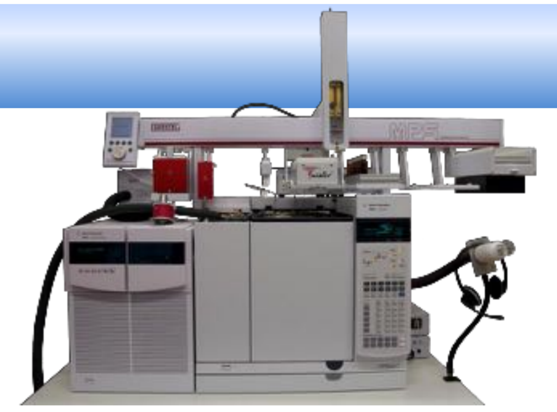
Abb. 1: Gaschromatograph mit Tandem-Massenspektrometer und olfaktorischem Detektor (GC-MS/MS-O)
