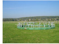
CO 2 -Anreicherungsring des Instituts für Pflanzenökologie der Uni Gießen
