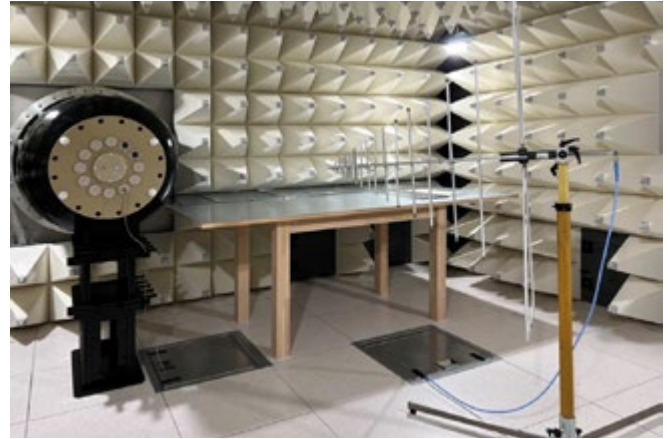
Anlage zur Elektromagnetischen Verträglichkeitsmessung von Ionentriebwerken im Betrieb
