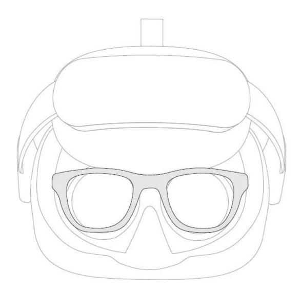
Installieren Sie den Brillenabstandshalter: Wenn Sie eine Brillenkollision mit der Headset-Linse oder Druck auf den Nasenrücken haben, folgen Sie bitte der Abbildung, um den Brillenabstandshalter zu installieren, um den Abstand zu vergrößern. Sie können entsprechend Ihrer Situation installieren oder nicht.
