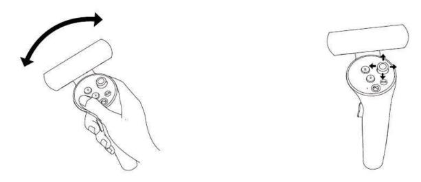
Schalten Sie den Zeiger des Master-Controllers um: Drücken Sie auf dem Startbildschirm kurz die TRIGGER-Taste des entsprechenden Controllers, um den Zeiger des Master-Controllers zu wechseln.
