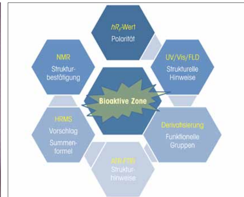
Abb. 3 Von der bioaktiven Zone zur Struktur: Hyphenations zur wirkungsbezogenen Analytik im analytischen Maßstab.
