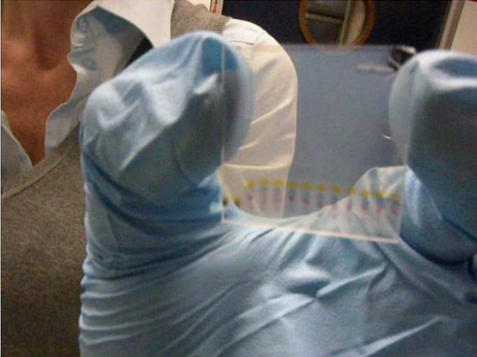
Abbildung 5: Opaleszente nanostrukturierte Trennschicht (Schichtdicke 5 µm)
