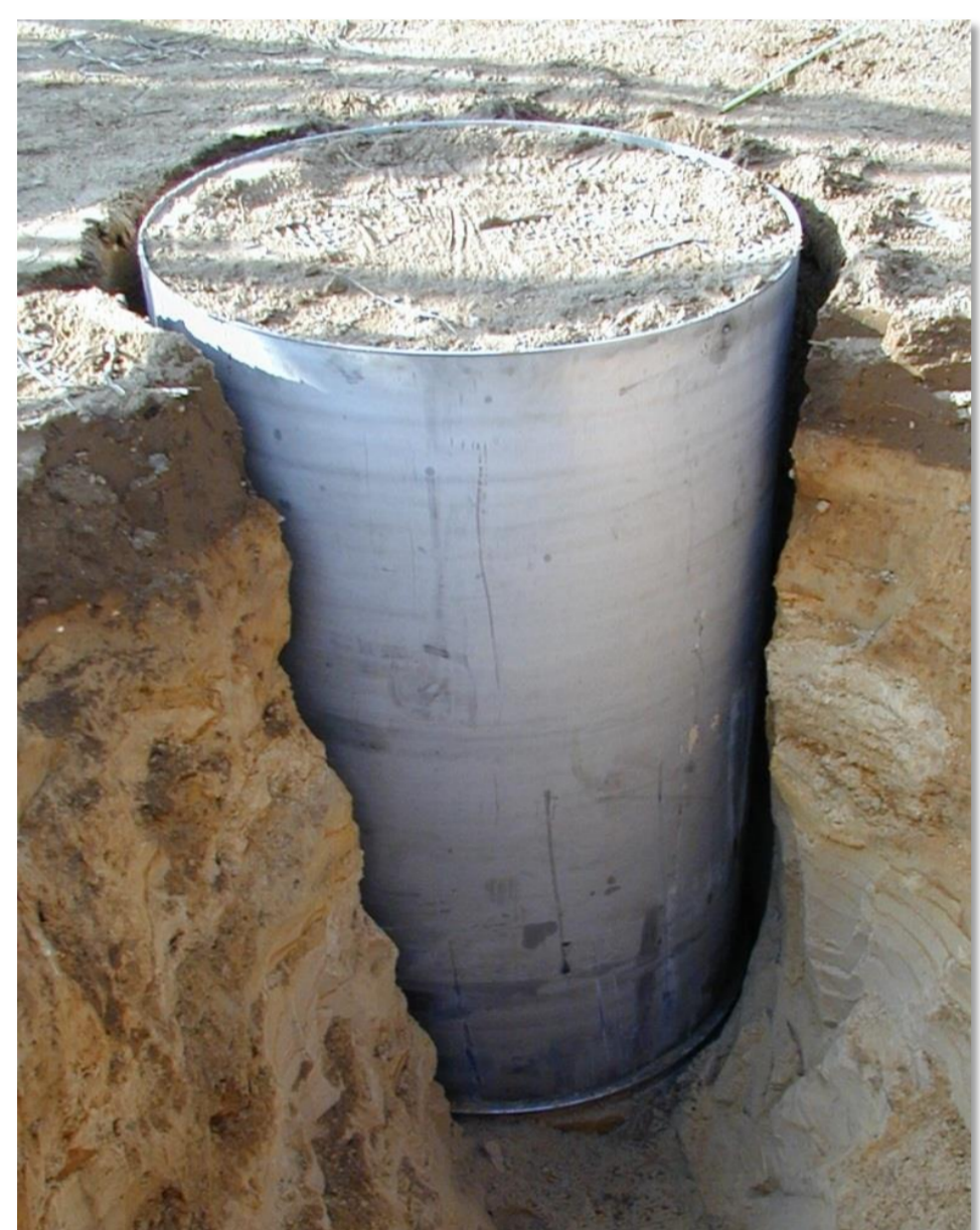
Abb.2: Ansicht der Bodensäule und schematischer Aufbau des Lysimeters
