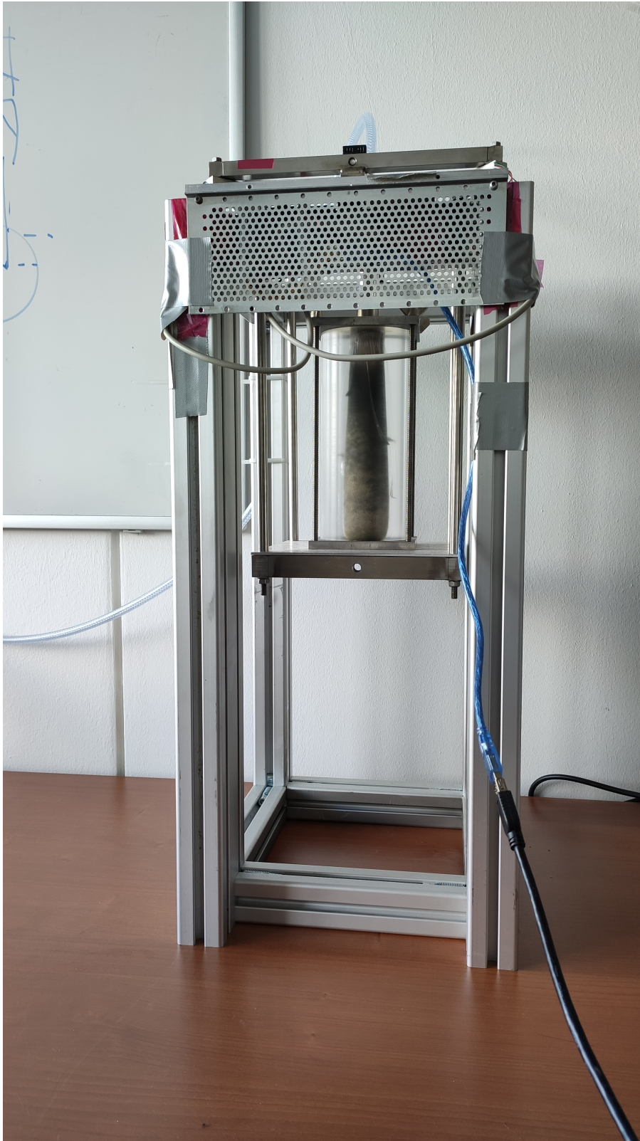
Abbildung 30: Aufnahme des fertig gebauten Messtands mit eingespanntem Triebwerk 48
