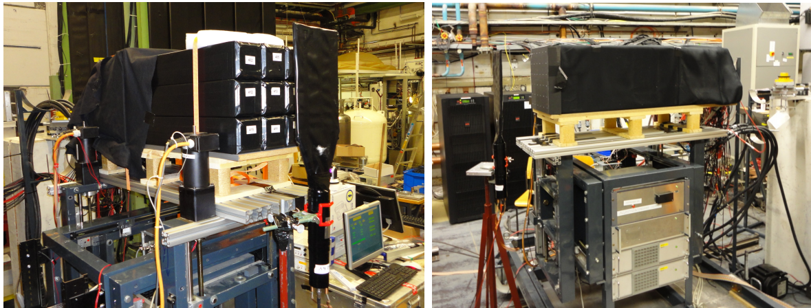
Abbildung 2.5: Realer Aufbau des Prototyps des Shashlyk-Kalorimeters in der Experimentierhalle A2 in Mainz. Die Matrix aus 9 Modulen mit jeweils 4 Untermodulen ist auf einem in x und y Richtung bewegbaren Tisch gelagert. In Strahlrichtung befindet sich ein Plastikszintillatorpaddel vor der Matrix um geladene Teilchen zu identifizieren und zurückzuweisen.
