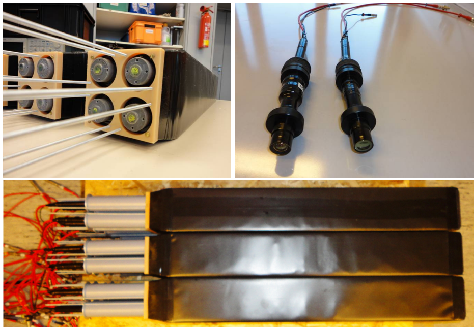
Abbildung 2.7: Fotos der Shashlykmodule ohne PMT (oben links) sowie der vormontierten Photomultiplier samt Spannungsteiler (oben rechts) und der fertig montierten Module (unten).
