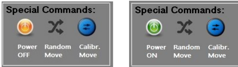
Figure A.7: Bedienoberfläche der Special Commands; zuständig für Ein- (links) und Ausschalten (rechts) der Motorsteuerung, sowie das Einleiten einer Zufallsbewegung und einer Kalibrationsbewegung.
