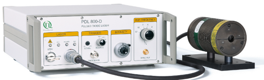
Figure 5.4: Verwendeter Infrarot-Laser mit zugehörigem Treiber [26].
