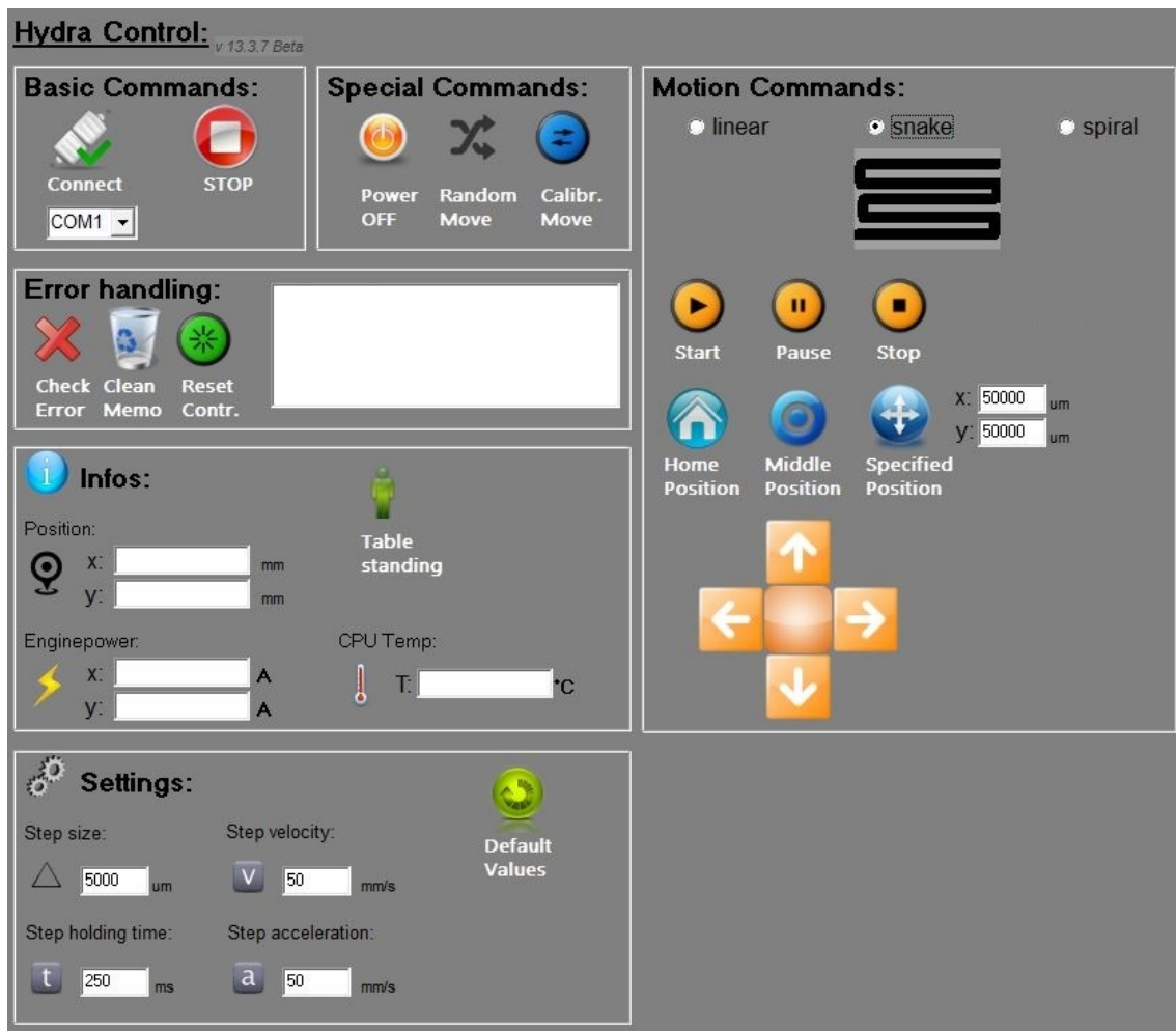
Figure A.5: Übersicht der programmierten Bedienoberfläche zur Ansteuerung des xy-Tisches.
