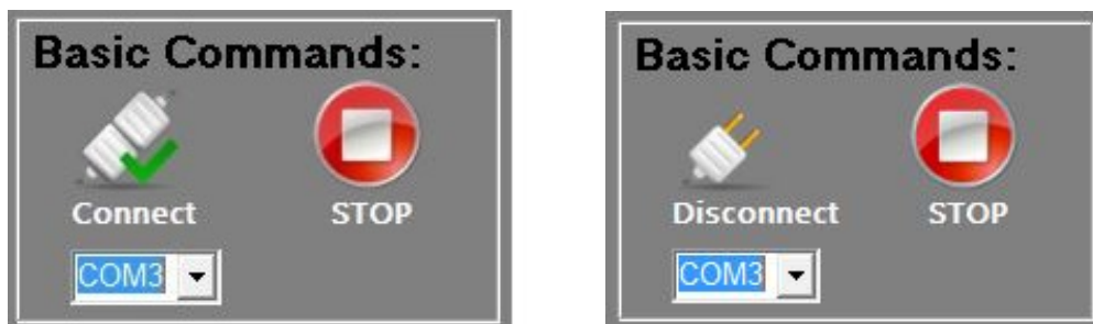
Figure A.6: Bedienoberfläche der Basic Commands; zuständig für das Aufbauen (links) und Trennen (rechts) der Verbindung, sowie das Notfall-Anhalten des Tisches.
