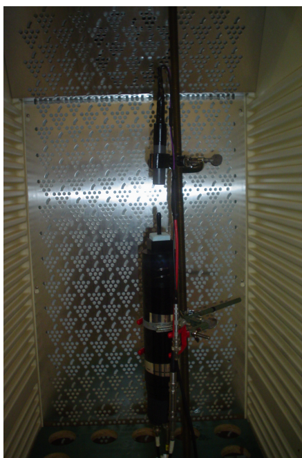
(a) Aufbau für die Messung mit dem PMT im Kühlschrank. (b) Aufbau für die Messung mit dem SiPM.
